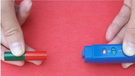
Drücken und halten Sie einfach den ovalen Knopf, siehe Photo links. Dann setzen Sie bitte die Spitze des Detektors auf die Oberfläche des Magneten. Falls es der Nordpol ist, wird die rote LED-Anzeige aufleuchten, falls der Südpol dann die grüne LED-Anzeige. Es ist sehr einfach. Und wenn man bei gedrücktem Knopf das Gerät über die Magnetoberfläche bewegt, kann man den Übergang von einem Pol zum anderen beobachten.
