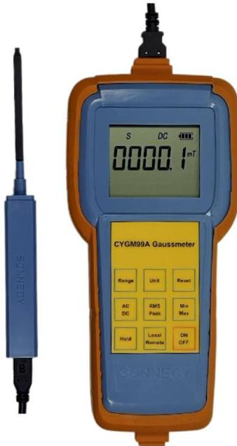
Das Gaussmeter CYGM99A arbeitet auf Grundlage des Hall-Effekt Messprinzips. Es ist ein mikroprozessor-gesteuerte Messgerät und kann zur Messung von DC/AC Magnetfeldstärken von permanentmagnetischen Materialien, Motoren, Lautsprechern, Magnetsensoren /-Wandlern, anderen Maschinen und Instrumenten usw. mit hoher Auflösung verwendet werden. Das Gaussmeter kann wahlweise mit 3 x AA Batterien (+1.5VDC) oder per USB-Kabel (+5VDC) betrieben werden.
