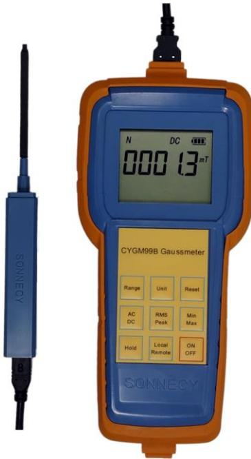
Das Gaussmeter CYGM99B arbeitet auf Grundlage des Hall-Effekt Messprinzips. Es ist ein mikrocontrollergesteuertes Messgerät und kann zur Messung von DC/AC Magnetfeldstärken von permanentmagnetischen Materialien, Motoren, Lautsprechern, Magnetsensoren /-Wandlern, anderen Maschinen und Instrumenten usw. mit hoher Auflösung verwendet werden. Das Gaussmeter kann wahlweise mit einem wiederaufladbarem Lipo-Akku(3.7V) oder per USB-Kabel (5V) betrieben werden.
