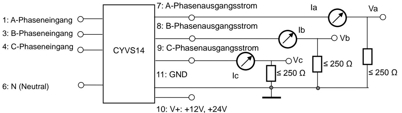
Beziehung zwischen Eingang und Ausgang (für  $R_m=250 \Omega$ ):
