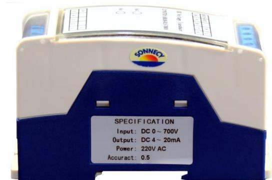
Abmessungen : 102mm x 42mm x 60mm
