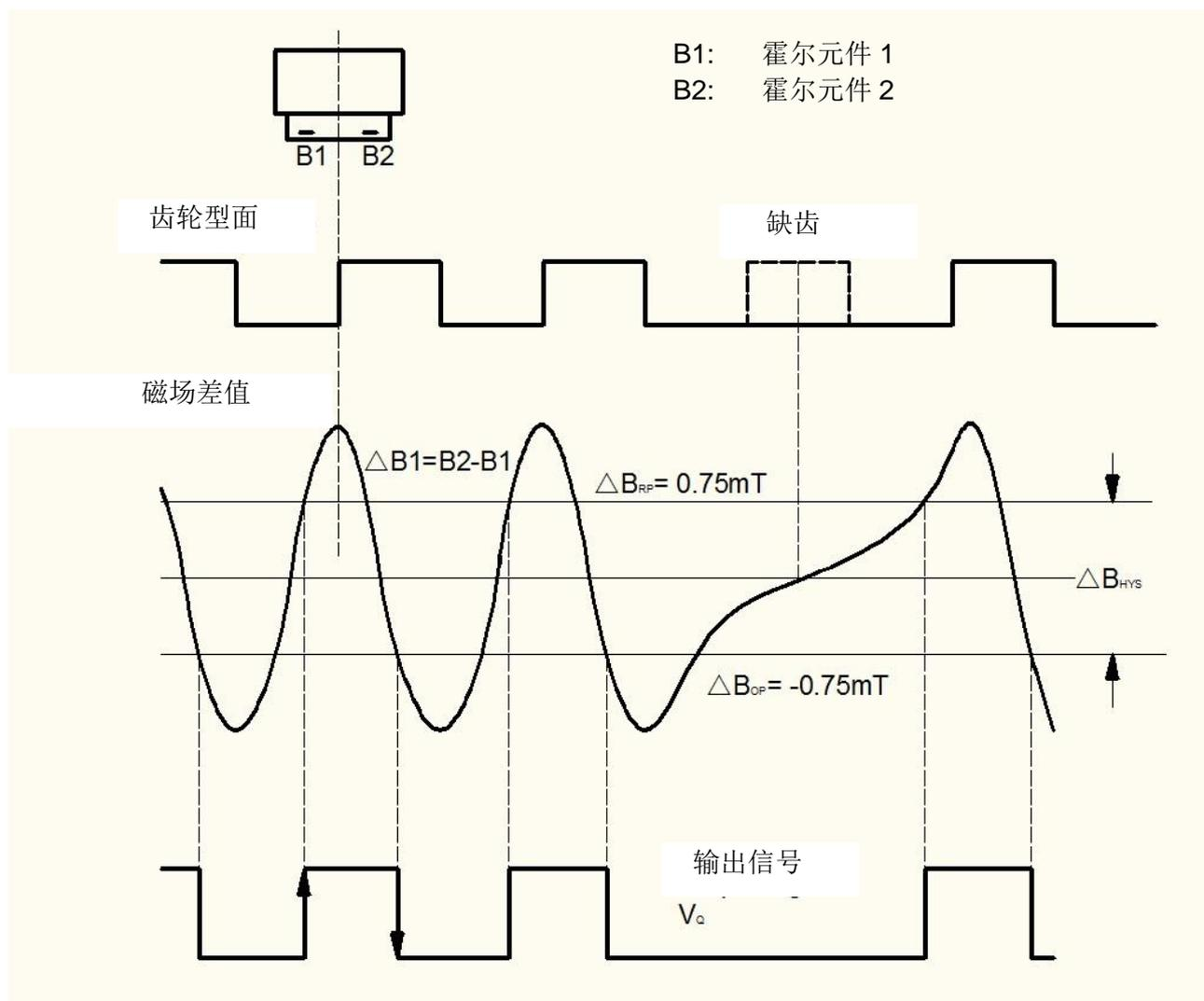
工作点:  $B_2 - B_1 < \Delta B_{OP}$  开关处于导通状态(输出低电平)
