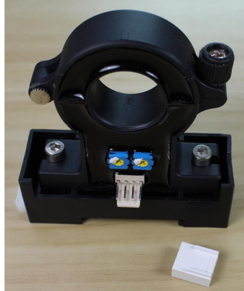
带 Molex 连接器的传感器 (从底部到孔中心的距离是 54.8mm)
