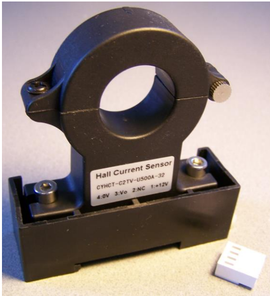
带 Molex 连接器的传感器 (从底部到孔中心的距离是 54.8mm)
