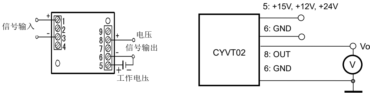
5: +15V, +12V, +24V 工作电源 6: GND 接地 8: 电压输出
