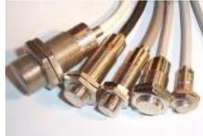
与磁电，光电和电容式接近开关相比，霍尔接近开关具有输出波形好、稳定性高、成本低、不受油污和振动影响、工作温度范围大等优点。该开关非常适合安装在计算机系统和各种工业控制设备上，并且是用来进行位置控制，速度测量，计数，方向检测和自动保护等工作的最佳选择。
