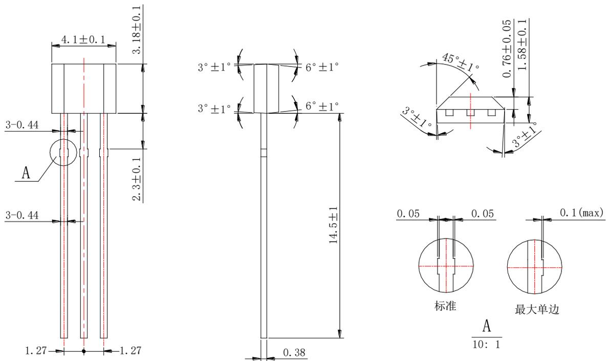
**Stifanordnung:** 1. Versorgungsspannung, 2. Erdung, 3. Ausgang
