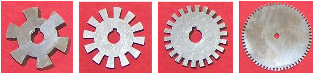
Die Merkmale variieren aufgrund von Maßen, Geometrie, Position, und Material des Messzahnrad. Die optimale Sensorleistung ist abhängig von folgenden Variablen und müssen in Kombination miteinander betrachtet werden:
