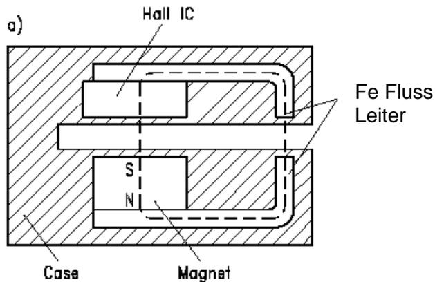
a) Magnetischer Fluss durch den Halleffekt-Schalter ohne Fe-Blech im Luftspalt
