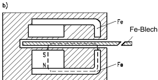
b) Magnetfluss ist kurzgeschlossen vom Fe-Blech
