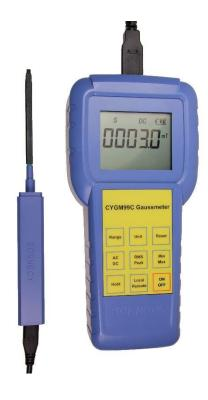
Das Gaussmeter CYGM99C arbeitet auf Grundlage des Hall-Effekt Messprinzips. Es ist ein mikrocontrollergesteuertes Messgerät und kann zur Messung von DC/AC Magnetfeldstärken von permanentmagnetischen Materialien, Motoren, Lautsprechern, Magnetsensoren /-Wandlern, anderen Maschinen und Instrumenten usw. mit hoher Auflösung verwendet werden. Das Gaussmeter kann wahlweise mit einem wiederaufladbarem LiPo-Akku(3.7V) oder per USB-Kabel (5V) betrieben werden.
