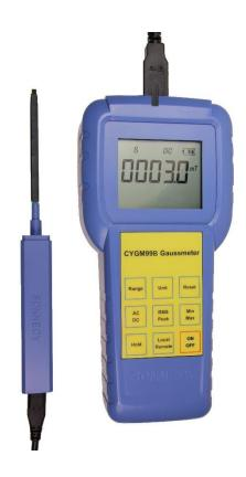
Das Gaussmeter CYGM99B arbeitet auf Grundlage des Hall-Effekt Messprinzips. Es ist ein mikrocontrollergesteuertes Messgerät und kann zur Messung von DC/AC Magnetfeldstärken von permanentmagnetischen Materialien, Motoren, Lautsprechern, Magnetsensoren /-Wandlern, anderen Maschinen und Instrumenten usw. mit hoher Auflösung verwendet werden. Das Gaussmeter kann wahlweise mit einem wiederaufladbarem Lipo-Akku(3.7V) oder per USB-Kabel (5V) betrieben werden.
